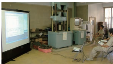
写真1: 生徒が装置(PC)を操作し参加型実験の体制で進める。実験値(グラフ)を確認しながら供試体の様子を観察
